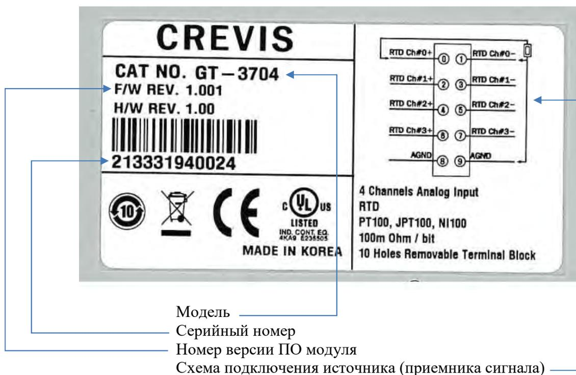
Рисунок 6 – Заводская информационная этикетка модуля серии G, S, R
