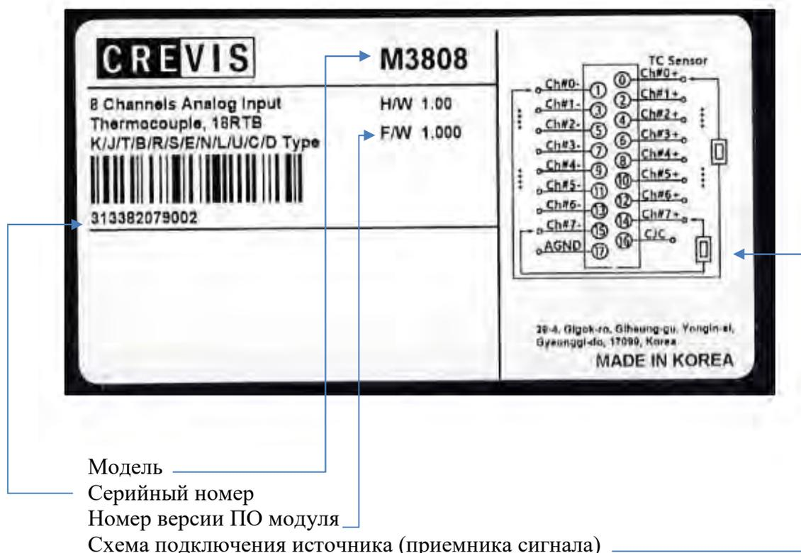
Рисунок 7 – Заводская информационная этикетка модуля серии М
